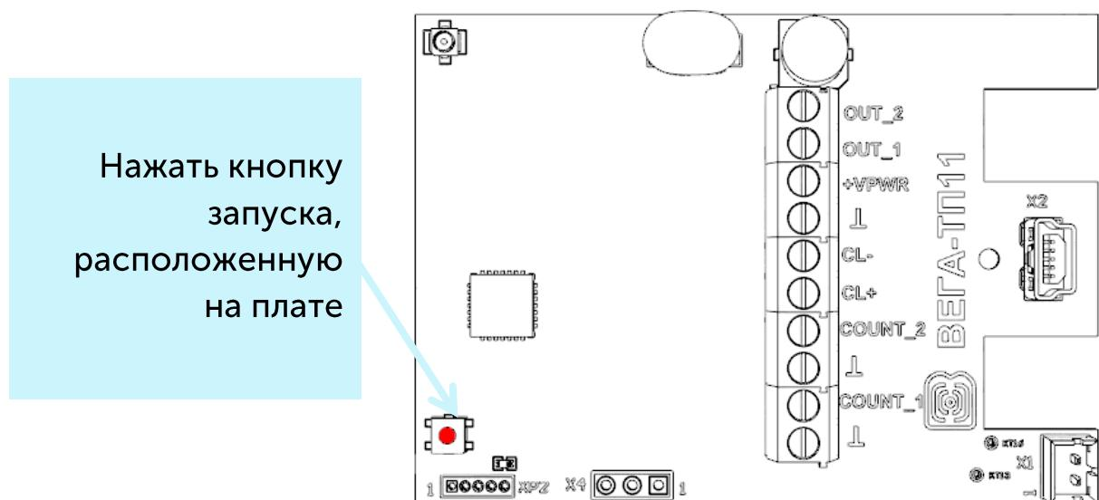
2. Способ ОТАА. После нажатия на кнопку запуска, устройство осуществит три попытки присоединения к сети в заданном при настройке частотном плане. При получении подтверждения активации в сети LoRaWAN, устройство подаст сигнал индикатором (свечение в течение 5 секунд) и перейдет в режим «Активный». Если все
